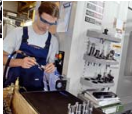
Entgratarbeiten während der Maschinenlaufzeit
