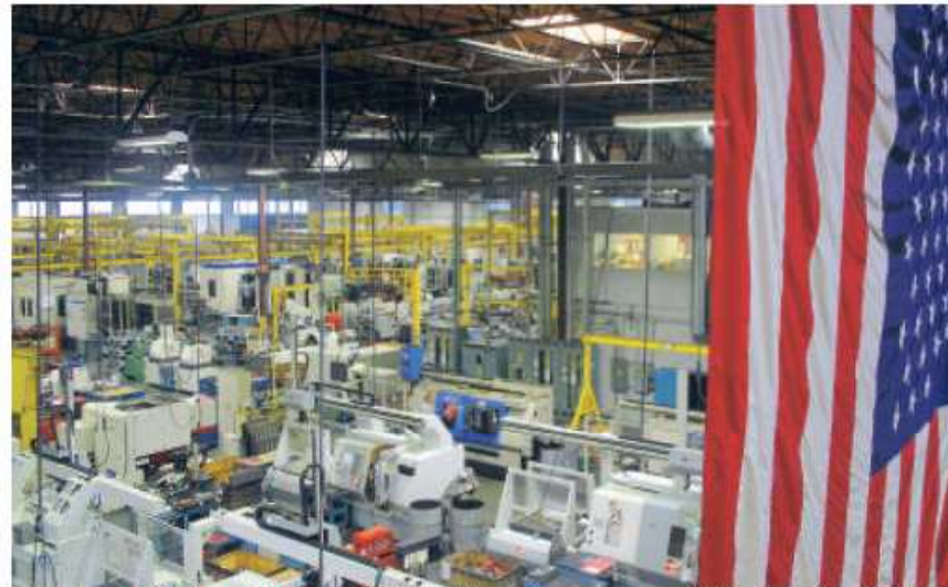
Ausgeprägte Fertigungstiefe ist Trumpf: Sämtliche Bauteile und Komponenten stammen in Kalifornien so weit wie möglich aus der eigenen Produktion. Und auch die eigenen Werkzeugmaschinen werden mit in die Fertigung einbezogen – wie die beiden im Bildvordergrund arbeitenden CNC-Drehmaschinen mit Gegenspindel vom Typ TL 25.
